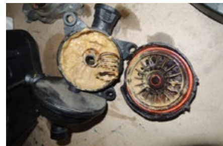
Znečištění v odlučovači oleje
