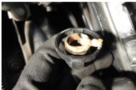
Olejový kal v odvodušňovací hadici
