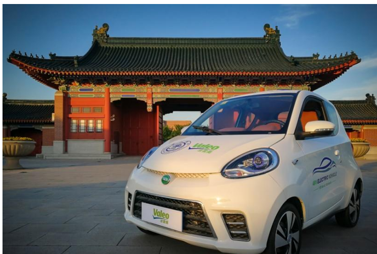
Prototyp malého vozidla se 48V elektrickou sítí byl vyvinutý ve spolupráci s Shanghai Jiao Tong University.
