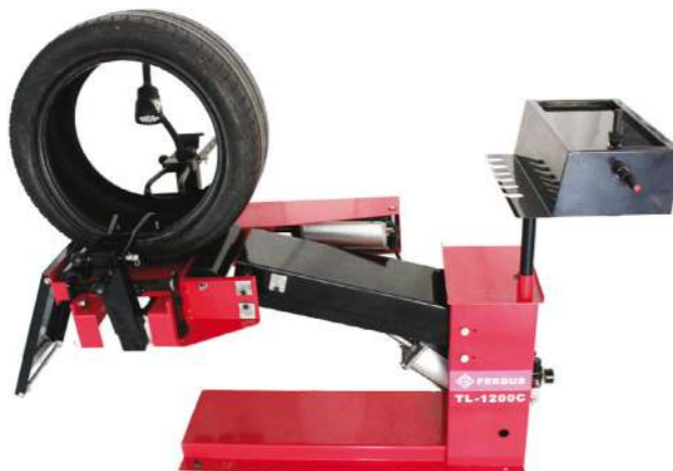
Ref. No. 111.29 Ozn. TL-1200C Kč/ks 29.900,- Popis Pneumatický roztahovák nákladních pneumatik
