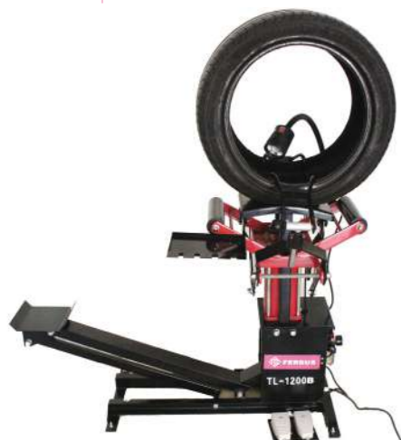
Ref. No. 111.28 Ozn. TL-1200B Kč/ks 19.900,- Popis Pneumatický roztahovák nákladních pneumatik
