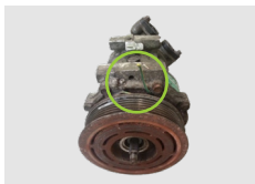
Konektor kompresoru uříznutý nebo částečně zlomený (>3 cm)
