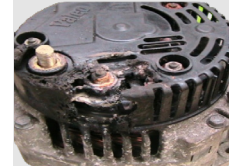
Extrémně spálené startéry, alternátory nebo kompresory
