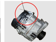
Alternátory s rozbitým montážním ramenem
