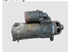
Startéry, alternátory nebo kompresory s lehkou korozi
