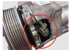
Poškozené startéry, alternátory nebo kompresory
