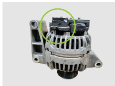
Alternátory s chybějícími nebo poškozenými ochrannými kryty
